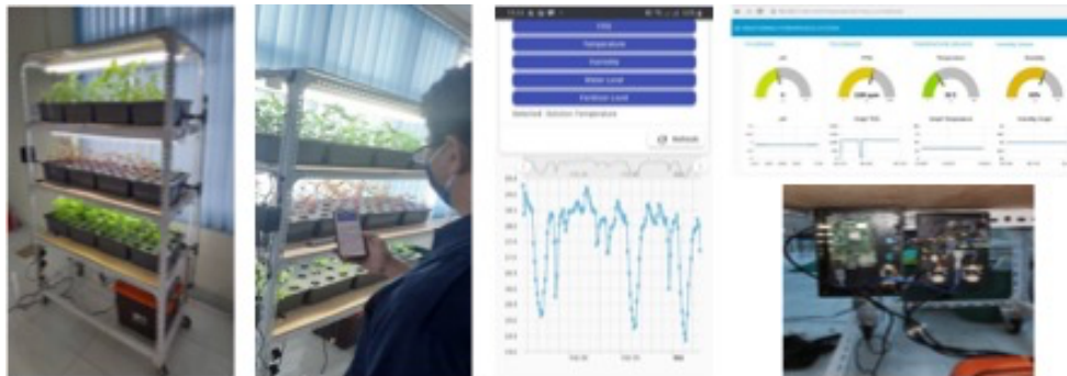
Gambar 4. Purwarupa sistem pertanian hidroponik berbasis AIoT indoor di laboratorium
